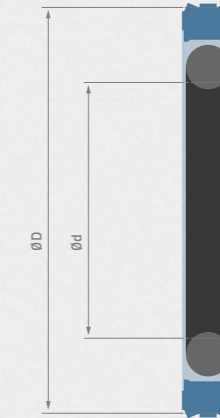
Abb. 1: Querschnitt der Kolbendichtung
